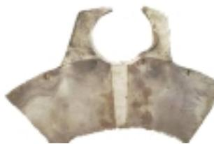
Fig. 8. Exemple de rupture d'un « bras » de fixation d'une liaison en deux points - *Example of rupture of a fixing "arm" of a point-to-point link*
