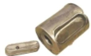
Fig. 9. Exemple de matage d'une clavette d'embrayage-frein - *Example of caulking of a clutch-brake system key*
