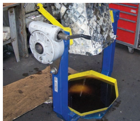
Appareil de maintenance de boîte de vitesses avec système de récupération d'huile
