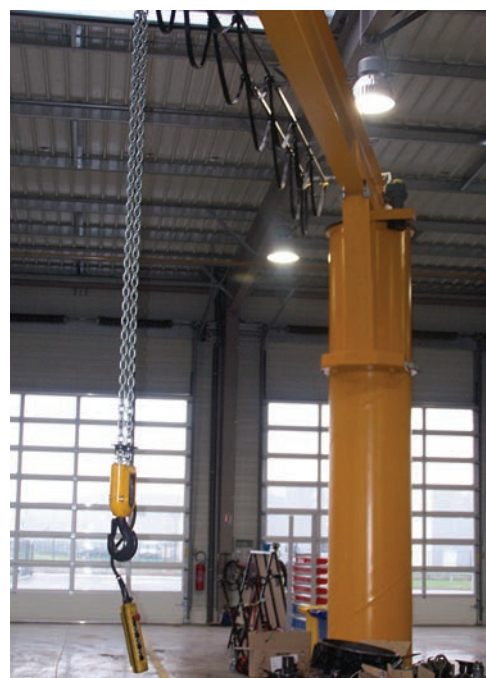
Potence avec rotation à 360 °C avec treuil pour couvrir deux travées
