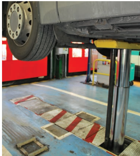
Pont à fût (la traverse baissée ne crée pas de butée au sol)
