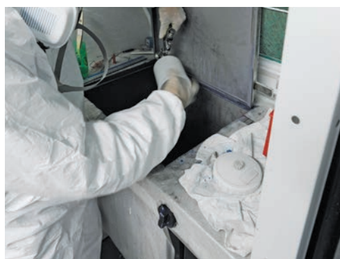
Poste de nettoyage des pistolets de pulvérisation de peinture hydrodiluable
