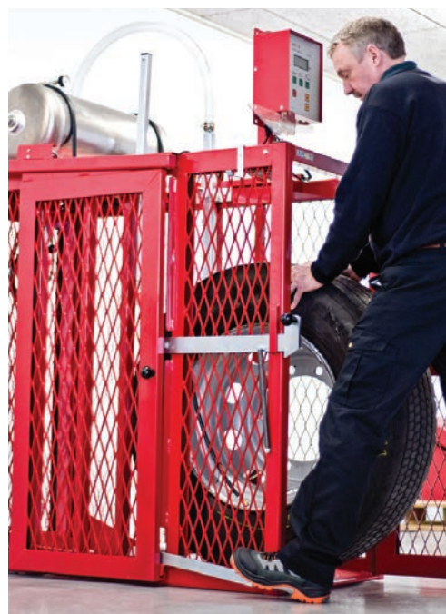
Cage anti-souffle pour le gonflage des pneumatiques. La cage est avec double paroi à mailles décalées afin, en plus de protéger des projections de matière, de « casser » le souffle projeté par un pneumatique qui explose.
