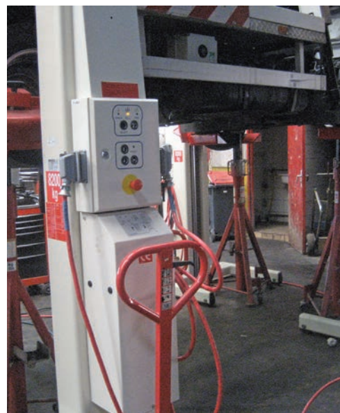
Véhicule levé à l'aide de colonnes mobiles et reposant sur des chandelles
