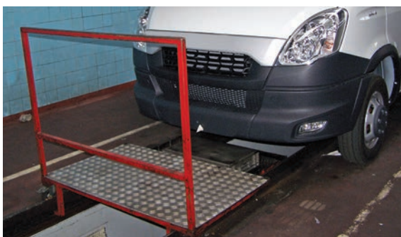
Chariot de vidange avec plate-forme de travail circulant sur rails de guidage latéraux
