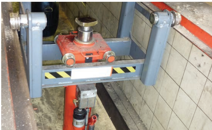
Vérin de fosse sur rails de guidage avec déplacement longitudinal sur la fosse et transversal sur le support vérin
