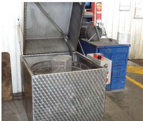
Machine de lavage lessiviel en circuit fermé
