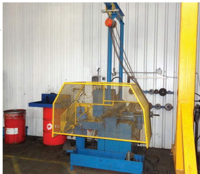
Tour utilisée pour la rectification des tambours : – un protecteur grillagé et basculant a été installé pour assurer la sécurité de l'opérateur, – un monorail avec palan facilite la mise en place des tambours sur la machine.
