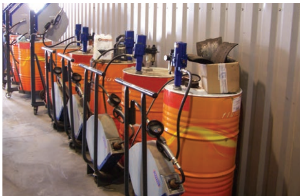
Fûts sur supports roulants et munis de cannes pneumatiques de graissage
