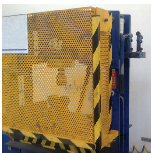
Presse hydraulique pour redresser, emmancher, remonter les roulements, etc.
