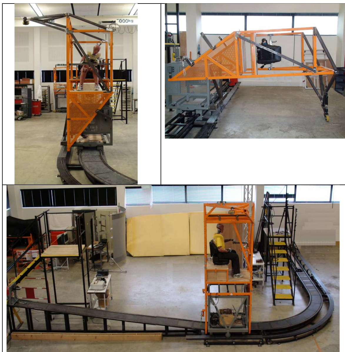
Figure 1 : banc d'essai pour générer les conditions d'un basculement complet de la réplique d'une cabine du commerce.
