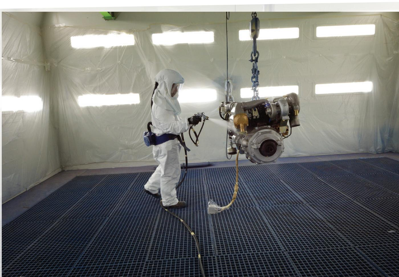
Photo 3 • Dégraissage avec une machine à jet sous pression.
