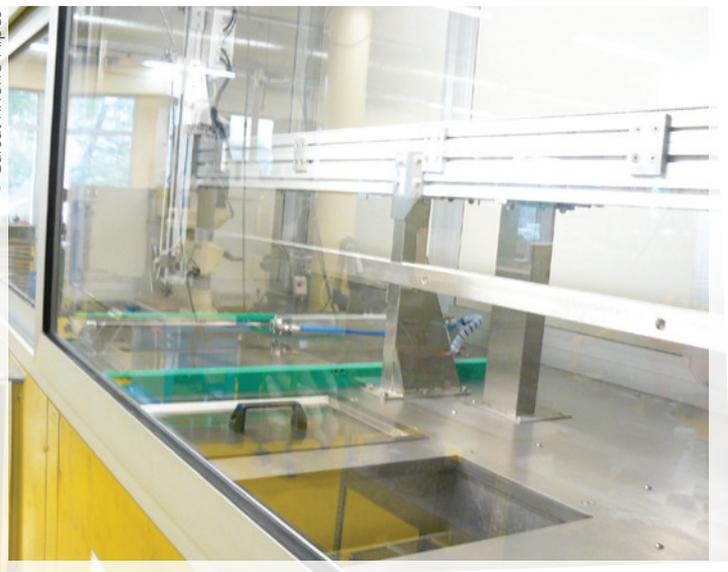
Photo 14 • Machine à cuves ouvertes capotée
