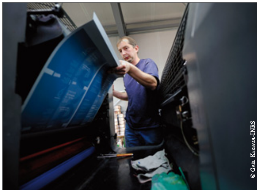
Changement de plaque offset sur une machine.
