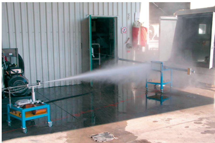
Banc d'essai « mesure de distance de dangerosité » Test bench for measuring jet danger distance
