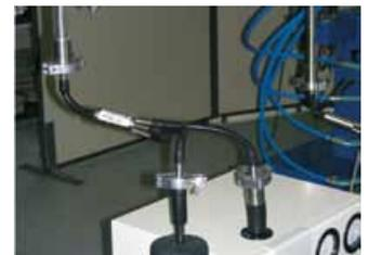
Prélèvement à l'aide du distributeur de débit (flow splitter)
