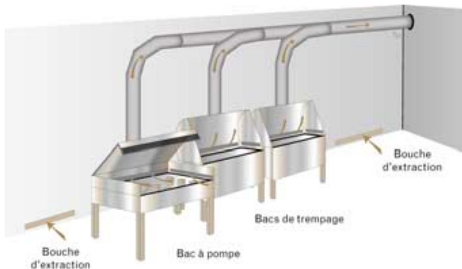
Plan de l'installation de l'atelier de nettoyage.
