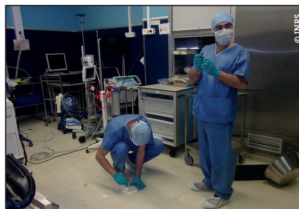
Photo 2 : Préleveur utilisant un gabarit de 10 cm de côté pour réaliser un prélèvement sur le sol.
