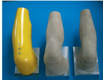
La force relevée au niveau du capteur 1 (*cf. Figure 1*) est systématiquement inférieure à celle des capteurs 2 et 3. La pression nulle obtenue dans la zone du capteur 1 avec le protecteur 43 est due à sa forme particulière qui élimine l'appui à l'avant du genou et le déplace au niveau du tibia.
