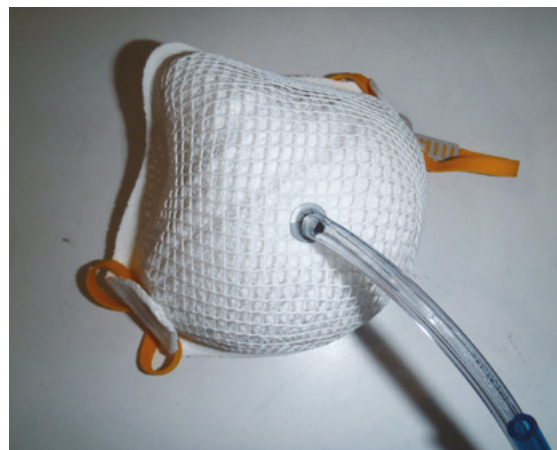
Figure 1. Adaptation d'un demi-masque filtrant pour la réalisation d'un essai d'ajustement quantitatif par comptage de particules.
