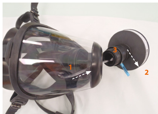
Figure 2. Adaptation d'un masque complet pour la réalisation d'un essai d'ajustement quantitatif par comptage de particules.
