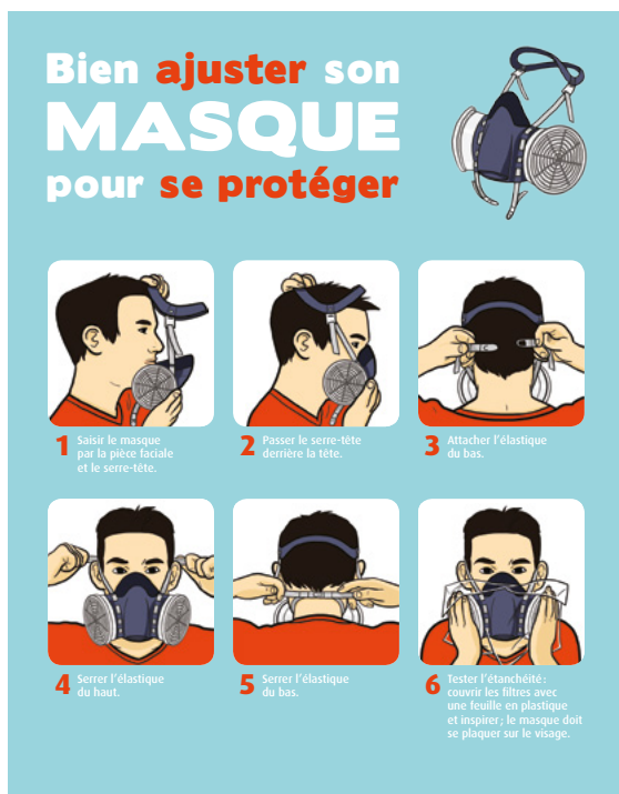
Figure 2. Contrôle d'étanchéité à pression négative
