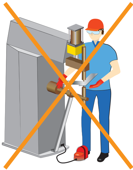
Figure 5. Position du poste de travail à éviter
