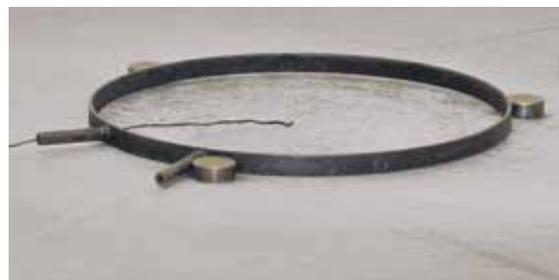
↑FIGURE 1 Vue du dispositif expérimental de mesure de la température minimale d'inflammation en couche de 5 mm, avec (à gauche) et sans produit (à droite).
