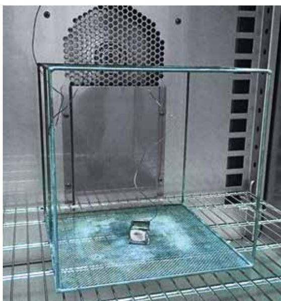
FIGURE 2 → Vue de l'intérieur d'une étuve, contenant le support de maintien du thermocouple et un cube rempli de produit à tester.
