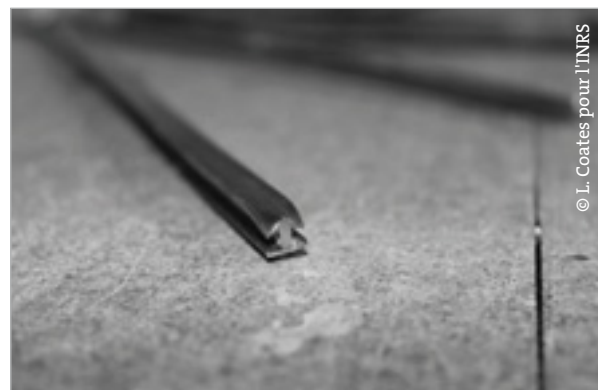
↑ Photo 2 : Baguette de plomb, avec aperçu de l'âme du plomb, en forme de « H ».
