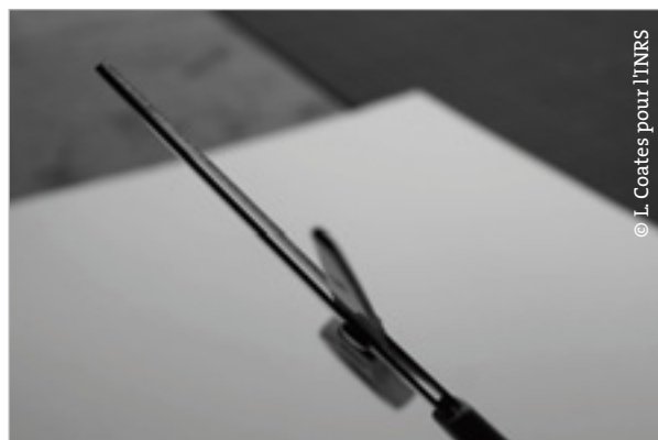
↑ Photo 3 : Ciseaux à calibrer à trois lames.
