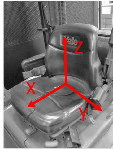
Fig.4 : Direction des vibrations
