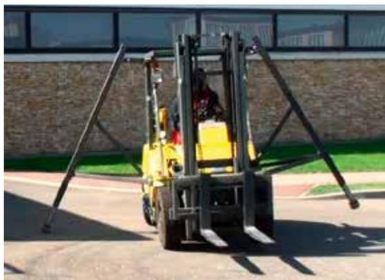
FIGURE 4 → Béquilles montées sur un chariot élévateur en situation de renversement partiel.
