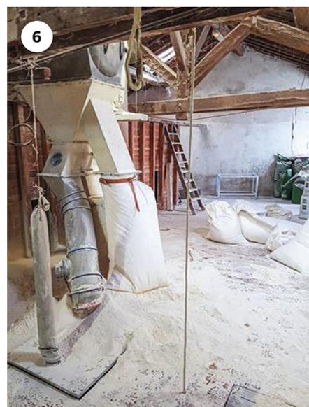
réseaux de transport pneumatique. Les installations de transport de matière et les machines de production sont raccordées à des réseaux de ventilation et de dépoussiérage.
