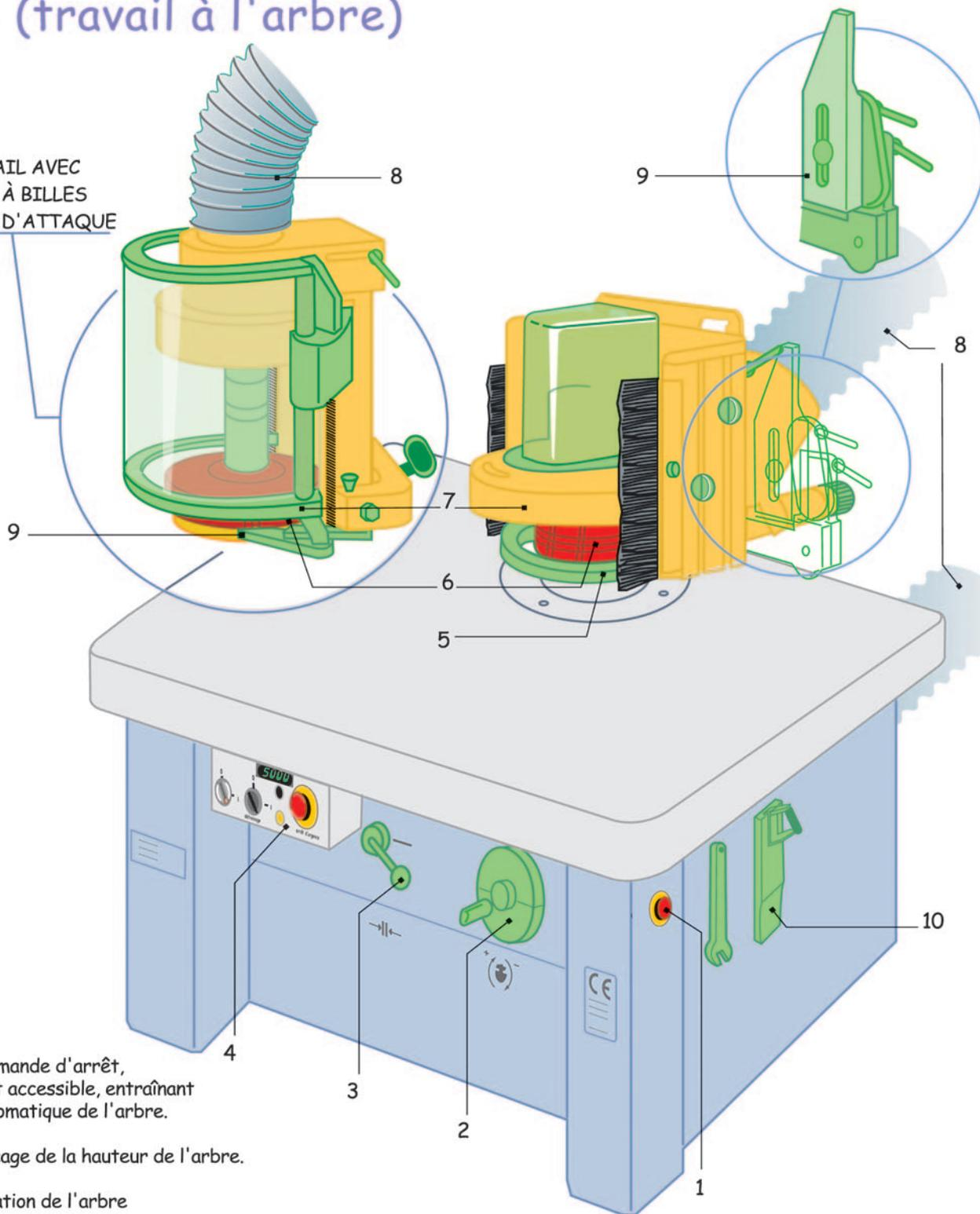
1 Organe de commande d'arrêt, très facilement accessible, entraînant le freinage automatique de l'arbre.
