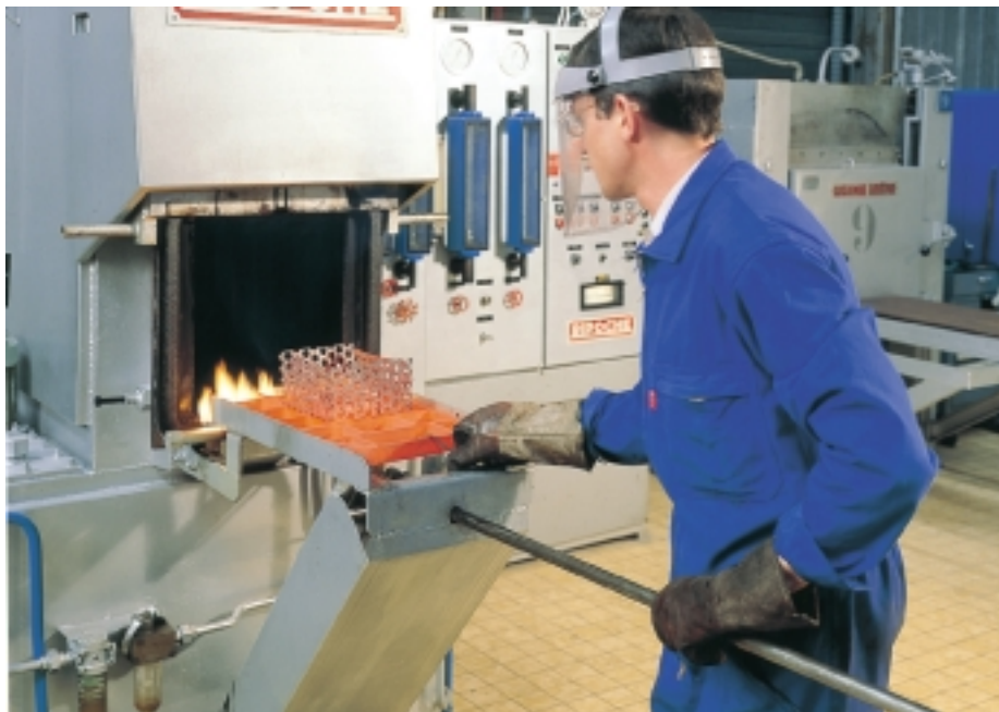
Fig. 2. Four de traitement sous atmosphère - Protective atmosphere treatment furnace
