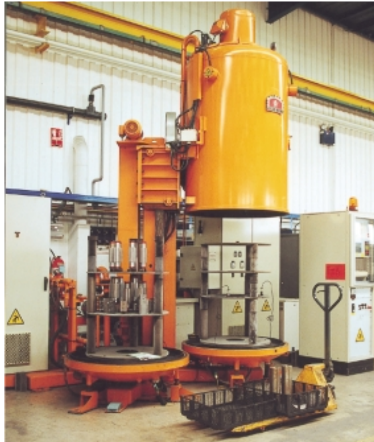
Fig. 1. Four de nitruration sous vide à double embase - Twin-seat vacuum nitriding furnace
