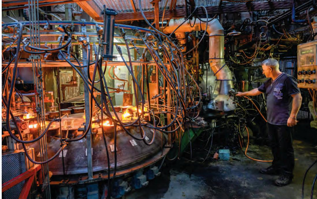
📷 Pour canaliser les fumées émises lors de l'enduction d'huile dans les moules, un système d'aspiration a été créé en interne.
