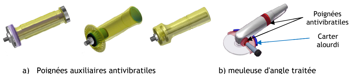
Figure 5 : Exemples de poignées antivibratiles pour meuleuses et de carter alourdi
