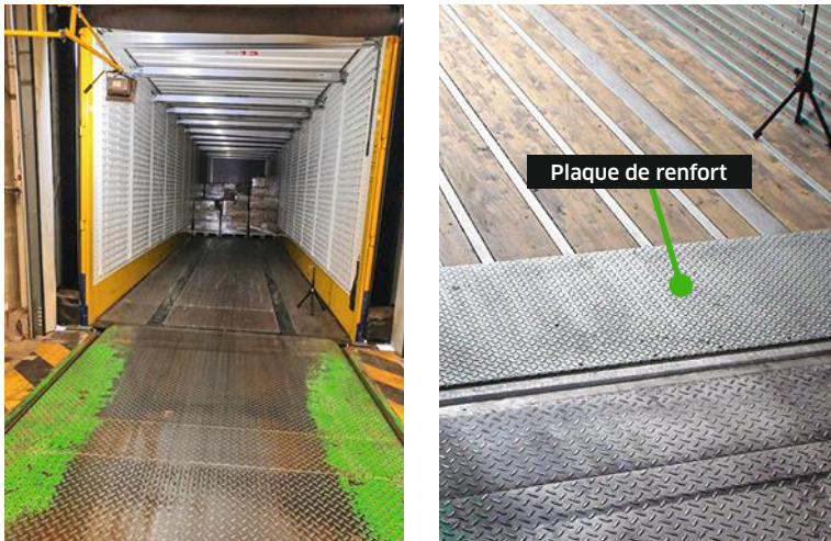
↑ FIGURE 1 Quai niveleur déployé sur un plancher en bois compressé (à gauche) et sur un plancher en bois avec renforts métalliques et une plaque de renfort à l'entrée (à droite).
