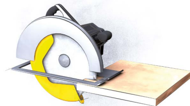
Protecteur réglable de scie circulaire portable à réglage automatique lors de l'avance de la lame
