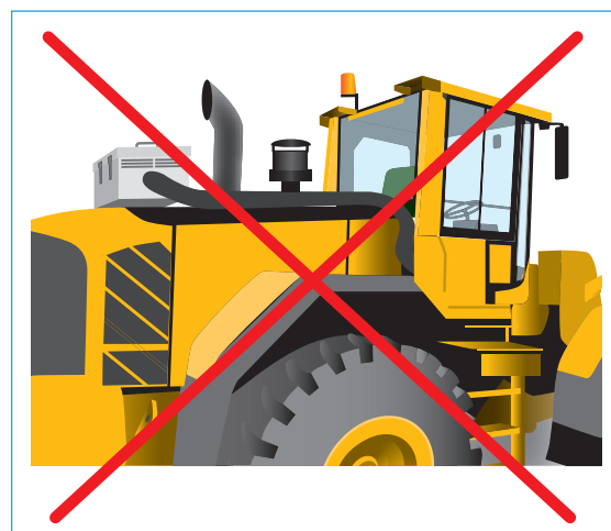
Figure 3. Pose du caisson d'épuration à proscrire
