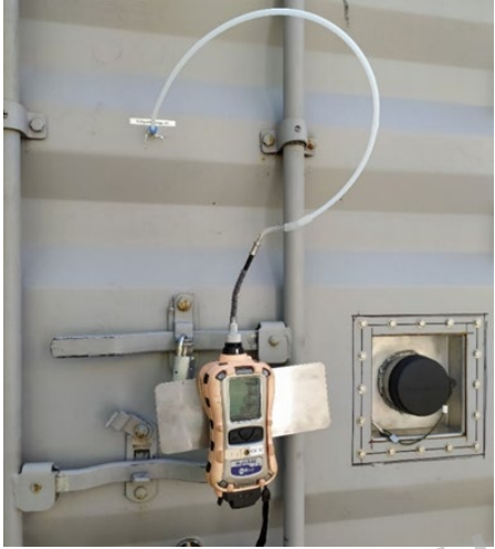
Prototype de ventilation nécessitant la modification des portes du conteneur (extraction 600 m 3 /h)
