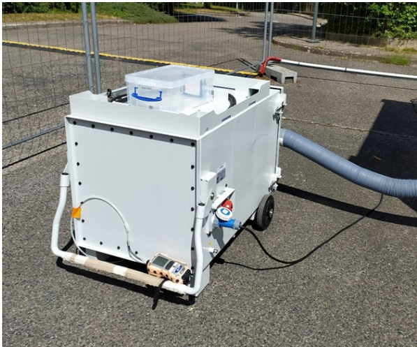
Prototype de ventilation nécessitant la modification des portes du conteneur (extraction 600 m 3 /h)
