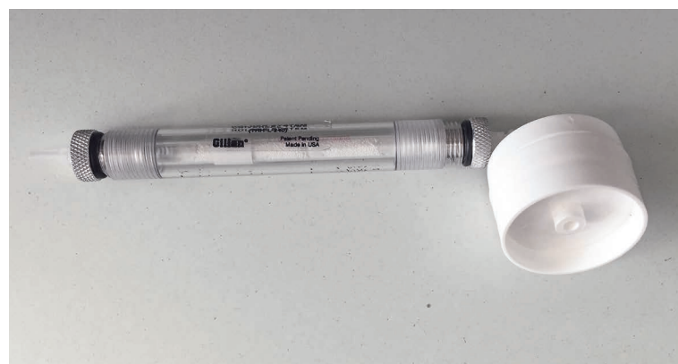
↓ FIGURE 3 Dispositif de prélèvement nouvellement développé pour le prélèvement de l'acrylamide dans l'air.
