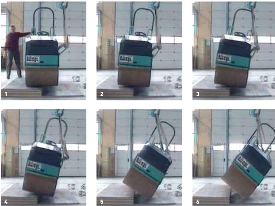
La même configuration d'essai a été simulée à l'aide du modèle numérique de mini-compacteur pour les deux hauteurs de trottoir. Pour une hauteur de trottoir de 135 mm, les calculs montrent que le mini-compacteur revient en position d'équilibre, en appui sur l'arête du trottoir, conformément aux essais (cf. Figure 9).
