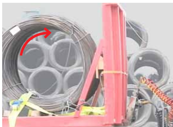
↑ FIGURE 1 Mouvement vers l'avant d'une couronne calée et arrimée transversalement, pendant un essai de freinage.
