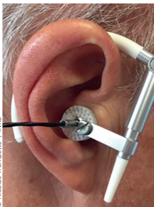
Photos 2. Exposimètre avec microphone miniature et dispositif support en place sur une oreille.
