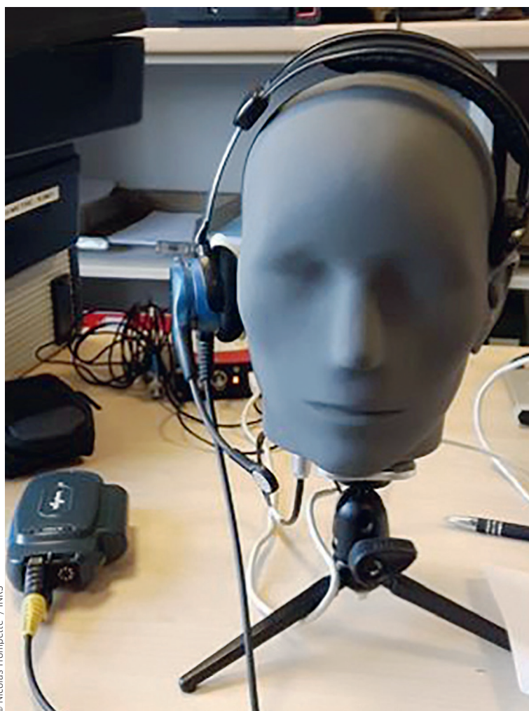
Photo 1. Simulateur de tête et torse (HATS) équipé d'un casque d'opérateur.
