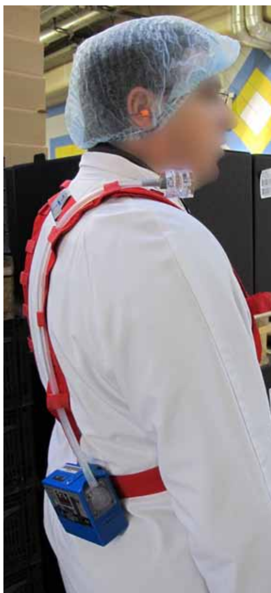
← FIGURE 1 Prélèvement individuel d'aérosols de moisissures réalisé sur un salarié
