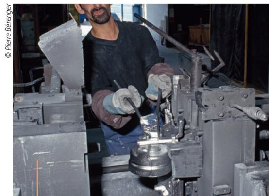
Extraction d'une pièce d'une coquilleuse
