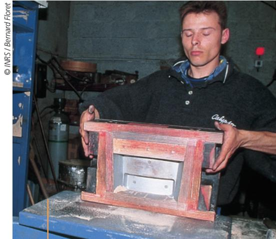
Table pivotante réglable en hauteur pour le transfert de boîtes à noyaux
