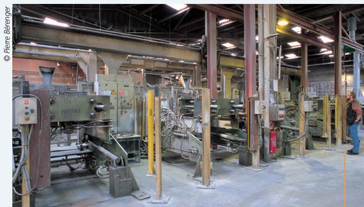
Vue d'ensemble d'un chantier de moulage automatisé comprenant plusieurs coquilleuses et robots de coulée
