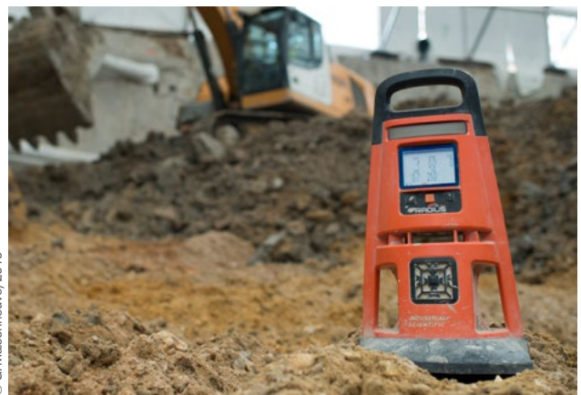
■ Photo 2 – Détecteur transportable de gaz (balise)
