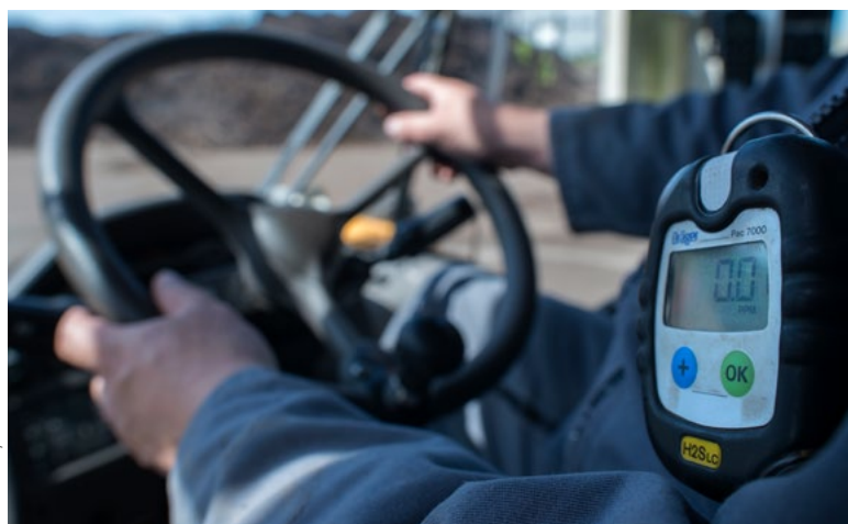
■ Photo 6 – Conducteur d'engin équipé d'un détecteur de sulfure d'hydrogène
