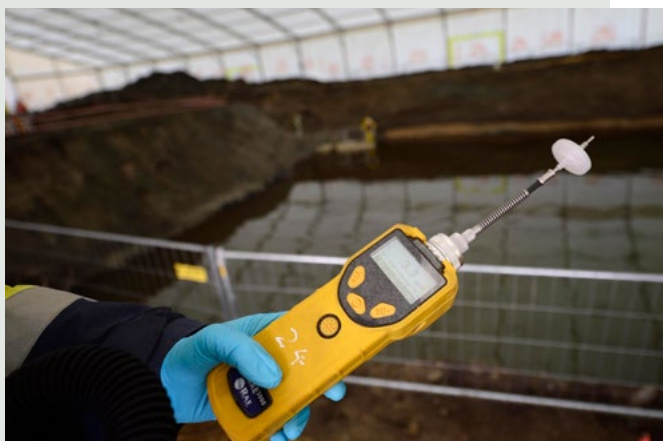
■ Photo 4 – Détecteur à photo-ionisation
