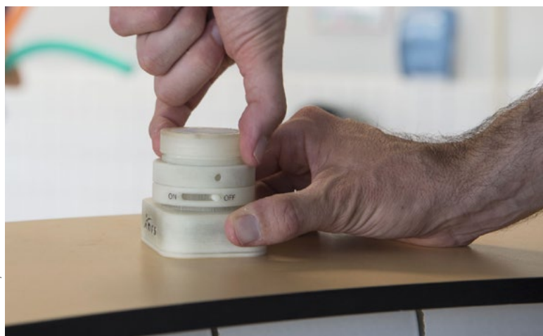
■ Photo 7 – Badge de prélèvement de trichloramine
