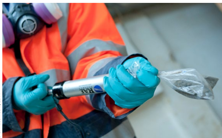
■ Photo 8 - Mesure par tube colorimétrique sur une carotte de sol pollué
