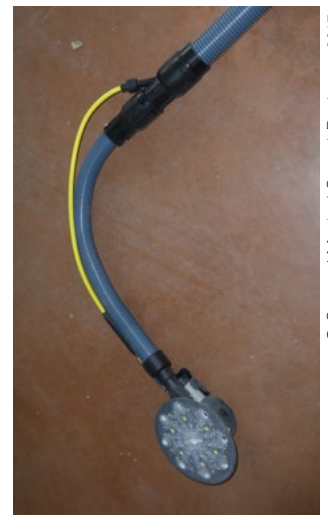
Photo 5. Ponceuse aspirante avec conduit bi-section
