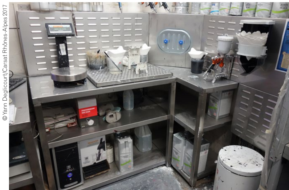
Photo 1. Poste de pesée et de mélange, incluant le captage des polluants émanant de la poubelle
