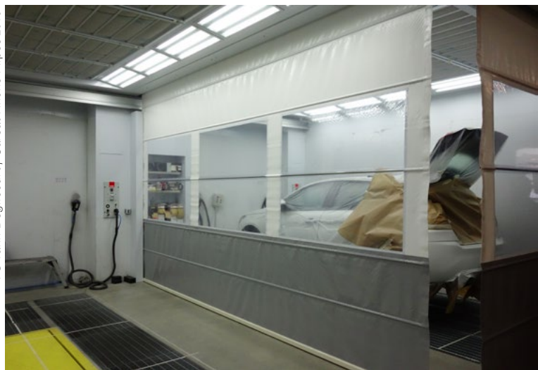
Photo 2. Vue d'une zone transformée en enceinte de préparation.
