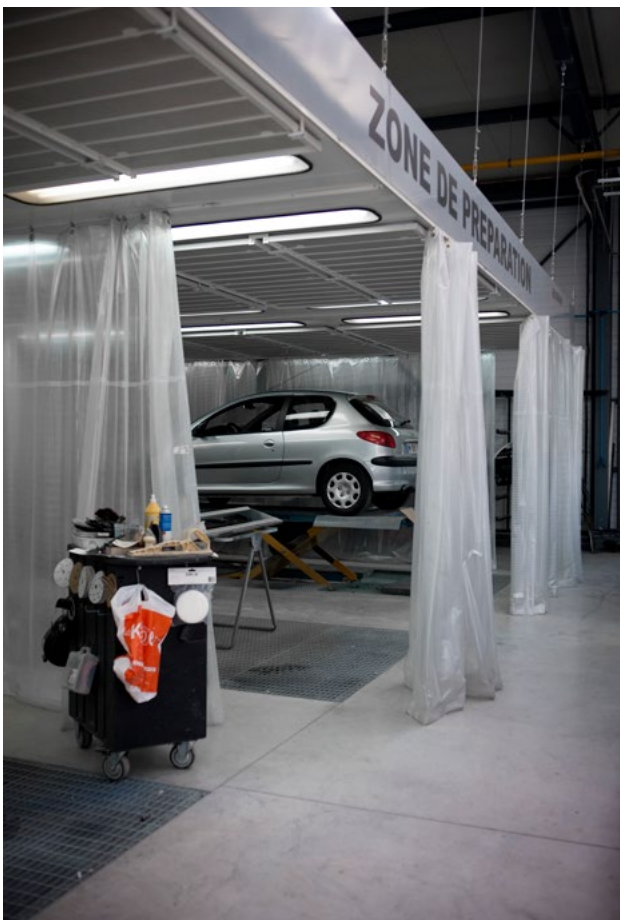
Photo 1. Enceintes de préparation de surface
