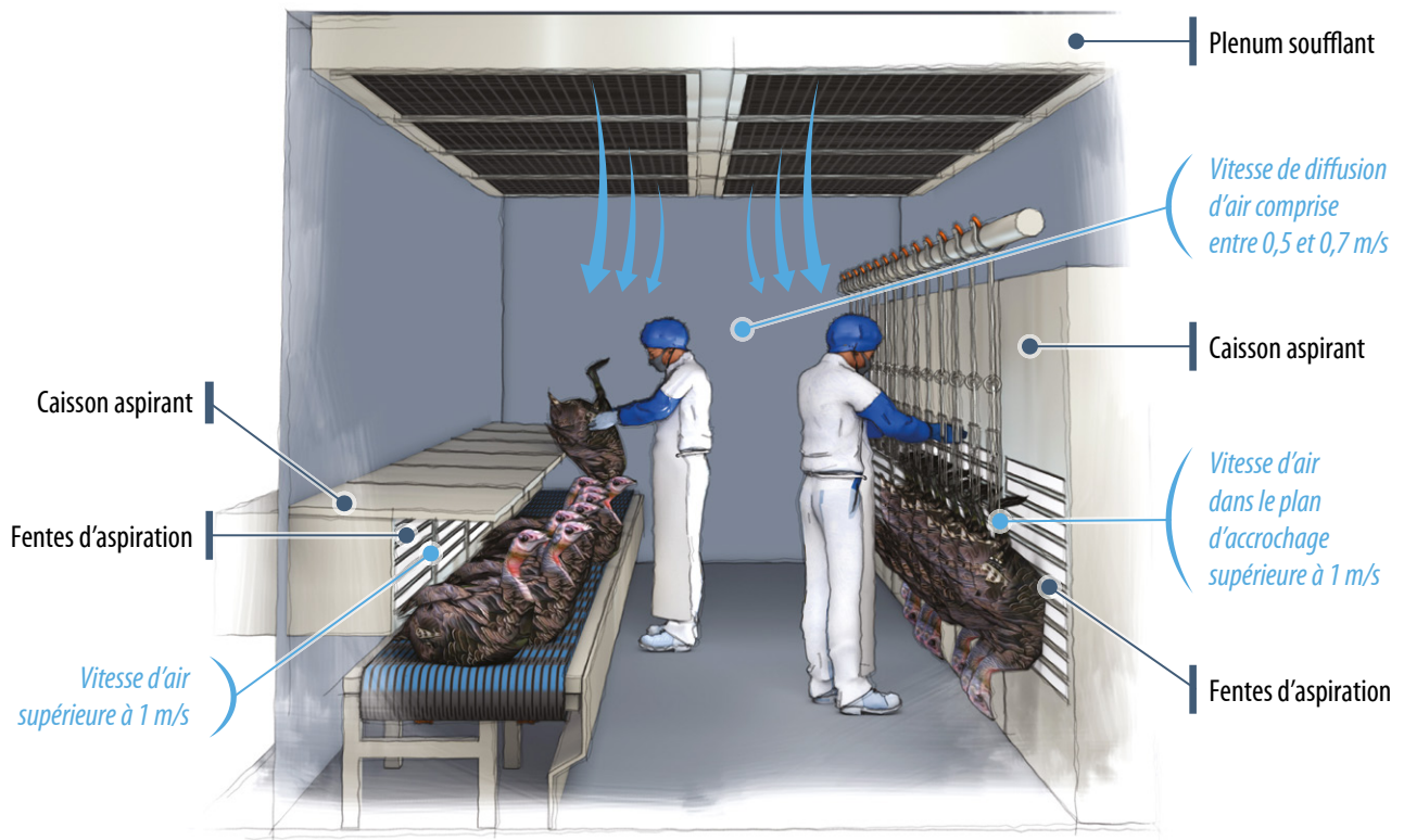
Figure 2. Solution pour une arrivée des volailles derrière l'opérateur a. Exemple avec soufflage de l'air neuf par plénum soufflant et aspiration à l'arrière du convoyeur aérien et du convoyeur d'acheminement
