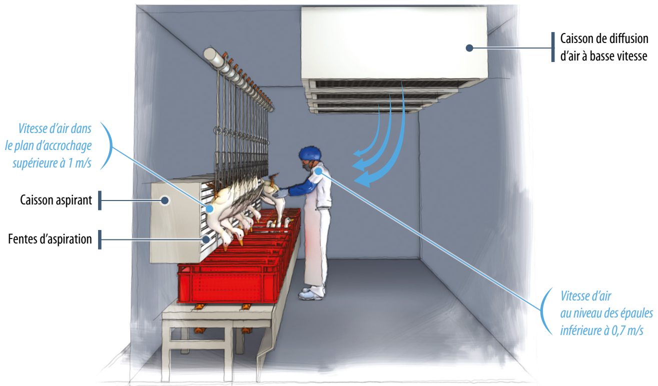
Figure 1. Solution pour une arrivée de volailles devant l'opérateur b. Exemple avec soufflage de l'air neuf par des caissons de diffusion basse vitesse et avec les caissons aspirants servant de tôle antistress
