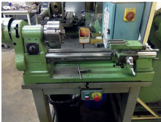
Figure 3. Exemple : tour de table débrayable manuellement adapté pour les opérations de reprise [Groupe EMI (72)] © Christophe Boudy / Carsat Pays de la Loire
