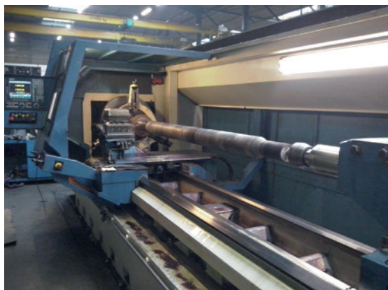
Figure 10. Système avec avance automatique du trainard, sans rotation de la bande abrasive
