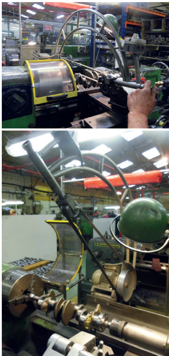
Figure 12. Équipement de travail motorisé solidaire du tour et actionné à la main [FARAL (53)] © Christophe Boudy / Carsat Pays de la Loire
