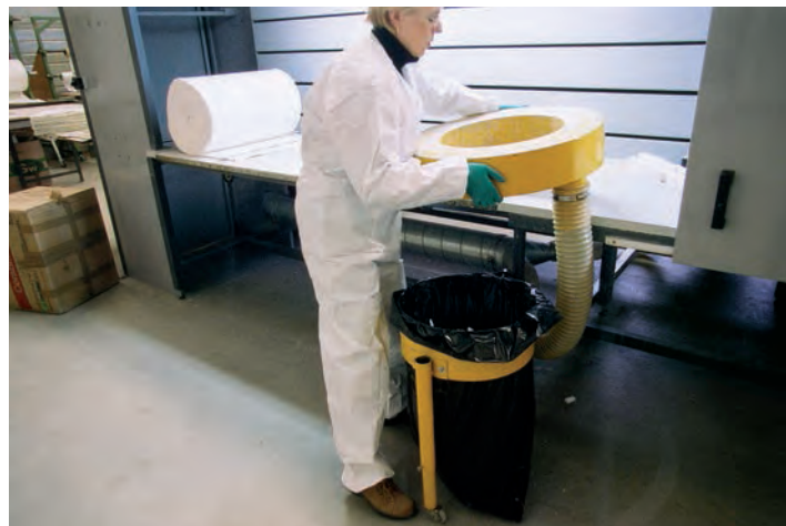
● Bac de déchets avec anneau aspirant en partie supérieure.
