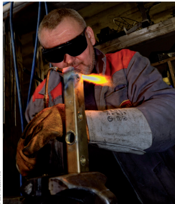
Figure 9. Opération de soudage à la flamme
