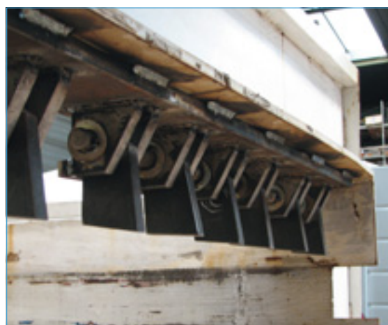
Figure 3. Rampe de linguets anti-retour.
