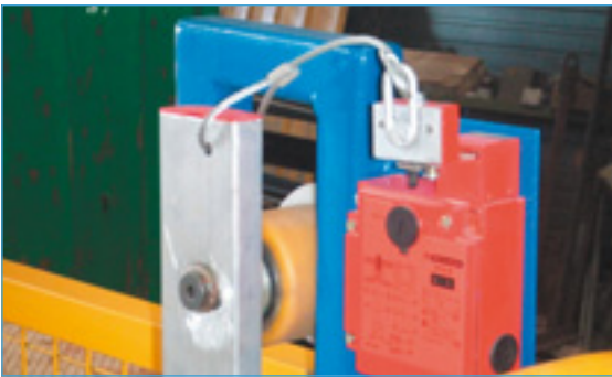
Figure 8. Contrôle de position et verrouillage de l'escalier intérieur.
