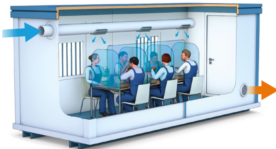
■ Figure 3 – Exemple de parois de séparation complétant la ventilation.
