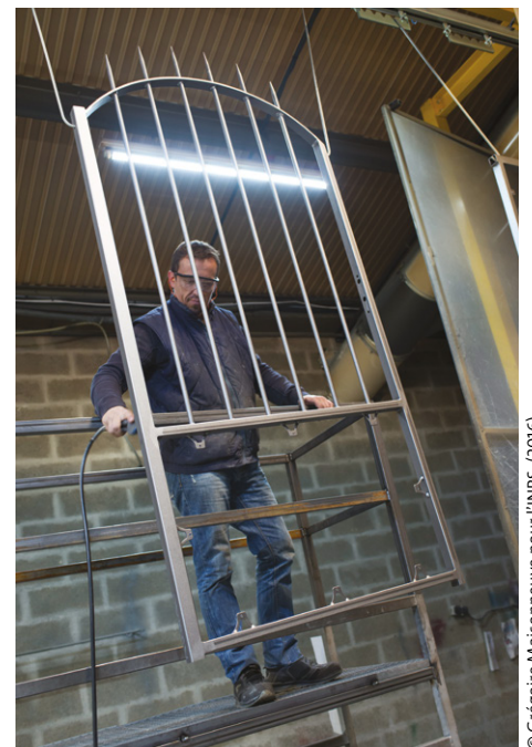
Une pièce sortant d'une cabine de grenailage
