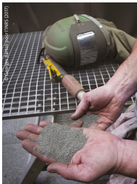
Matériau abrasif utilisé pour le grenailage de pièces métalliques
