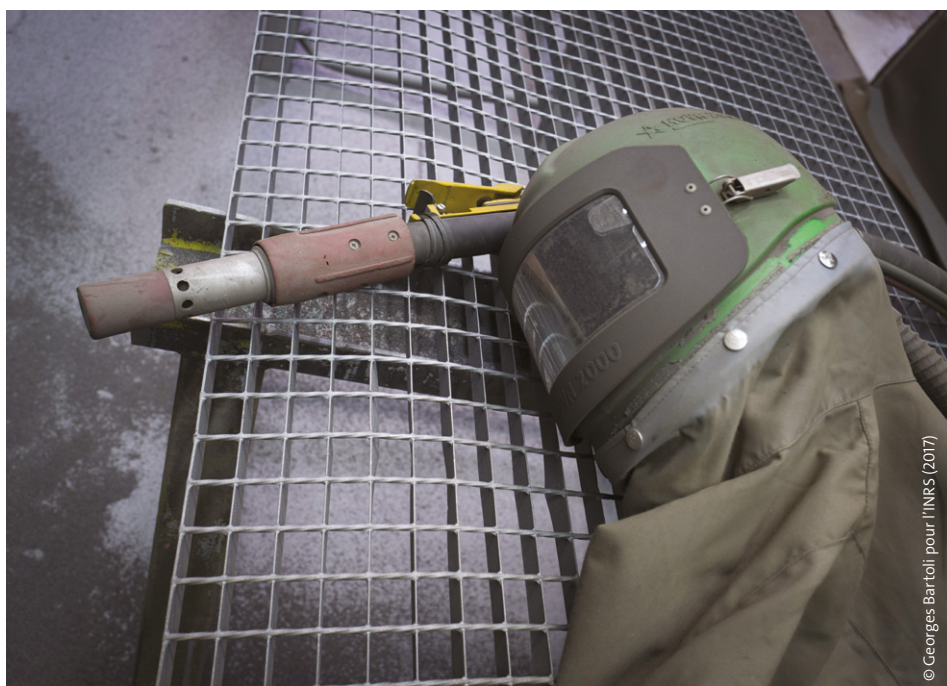
Système de projection d'abrasif, cagoule et combinaison de protection
