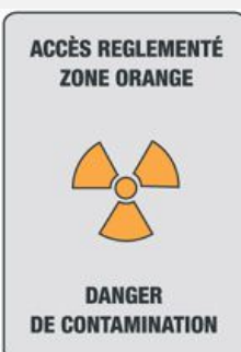
Zone contrôlée orange, danger de contamination
