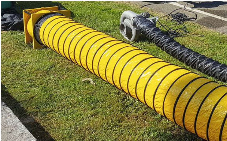
↑ PHOTO 3 Exemple de deux types de ventilateurs. Ceux-ci sont équipés de gaines souples annelées, étirées au maximum afin de favoriser au mieux l'écoulement de l'air insufflé dans l'ouvrage.
