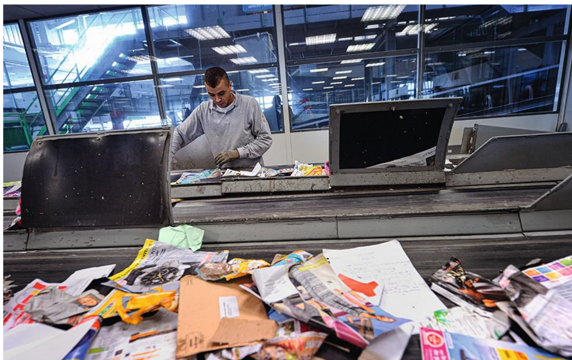
FIGURE 1 → Opérateur en charge du tri manuel des déchets dans une cabine de tri.
