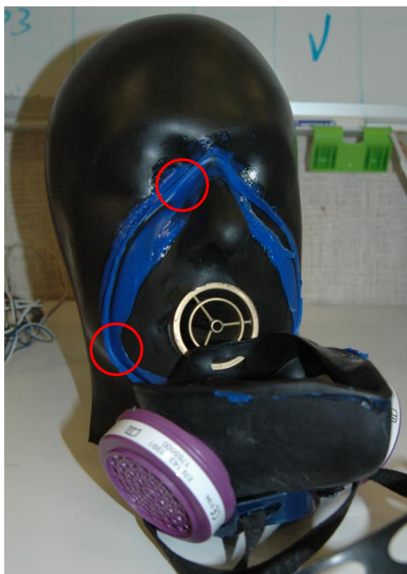
Figure 4-12. Visualisation des localisations des fuites sur le Sperian 7 000
