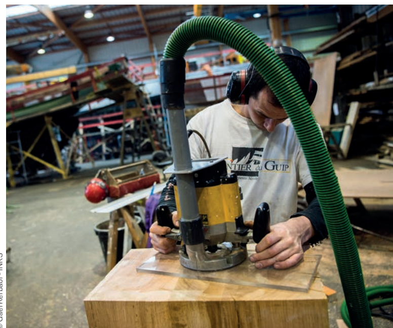
■ Défonceuse portative équipée d'un système d'aspiration des poussières
