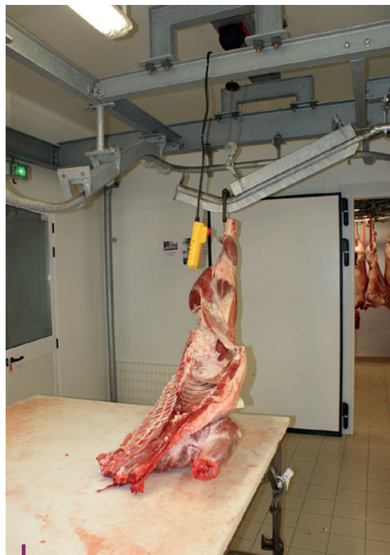
Monorail facilitant l'affilage des carcasses sur la table de découpe.
