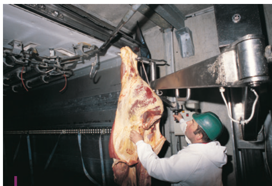
Bras de chargement hydraulique de manutention.
