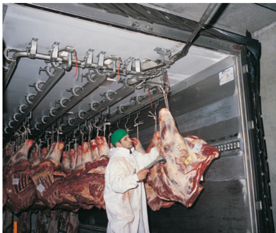
Réseau de rails raccordables.
