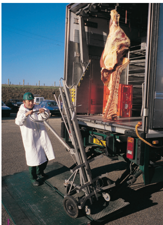
Le chariot d'aide à la manutention des carcasses : un outil de travail permettant de porter jusqu'à 200 kg de viande.
