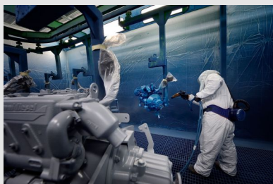
Cabine de peinture avec aspiration au sol
